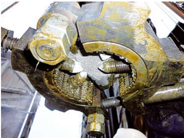
Рис. 3. Приспособление для фиксации керна ПФК-121/100
