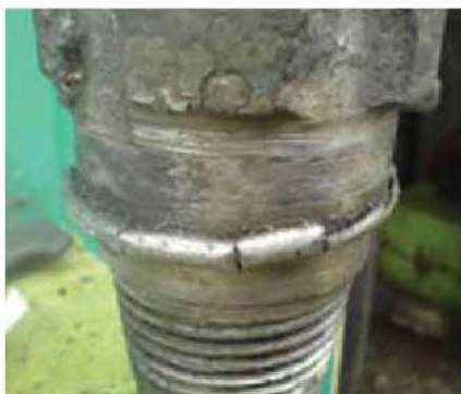
Рис. 2. Обуренное и извлеченное аварийное долото
