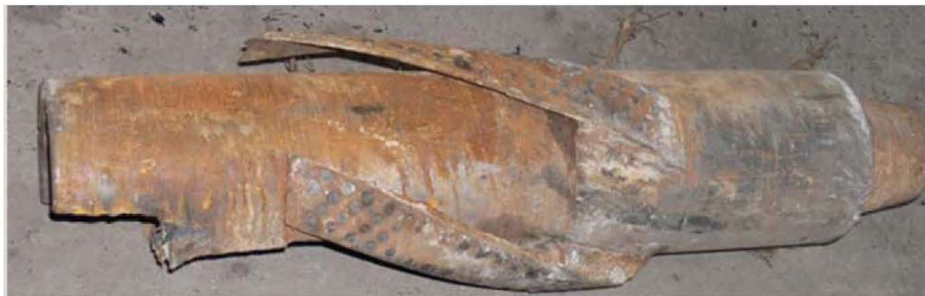
Рис. 1. Обуренный по лопастям и извлеченный аварийный калибратор
